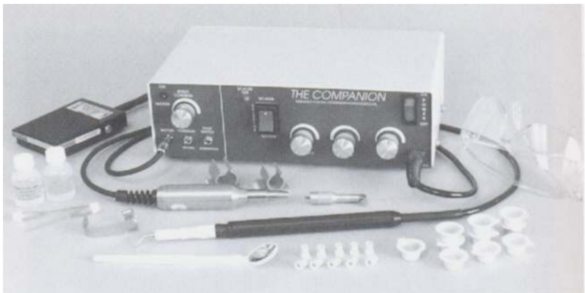
Figuur 4.7: Combinatie ultrasonische scaler – polijstapparatuur. (Bellows, 2004, p16)
